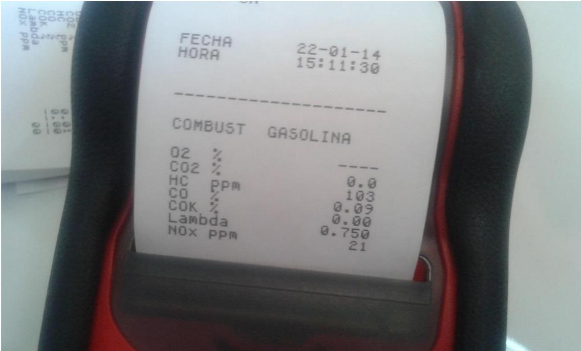
Esta fotografía muestra la segunda medición después de 30 minutos de estar el motor encendido con el aditivo para aceite RESURS TOTAL ENGINE
