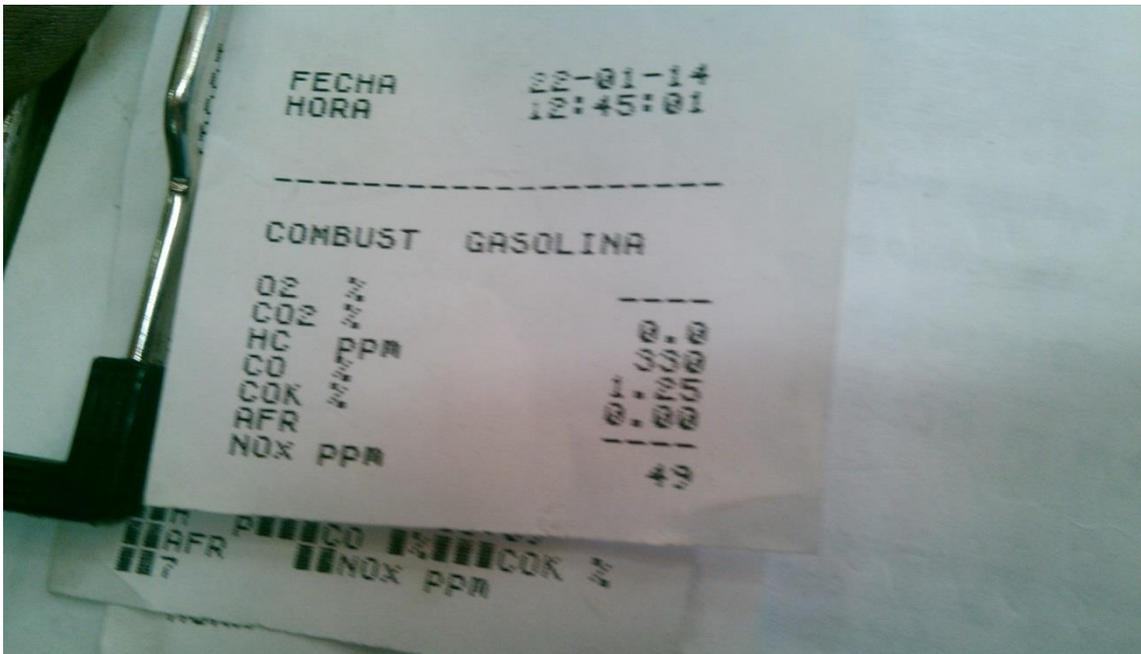
Primera lectura del analizador de gases snap-on al automóvil mark VI
