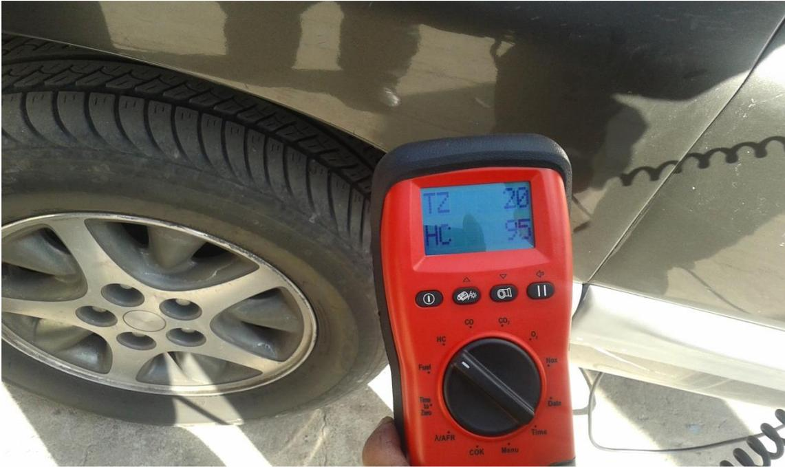
Toma de lectura de contaminantes 30 minutos después de aplicado el aditivo para aceite de motor RESURS TOTAL ENGINE
