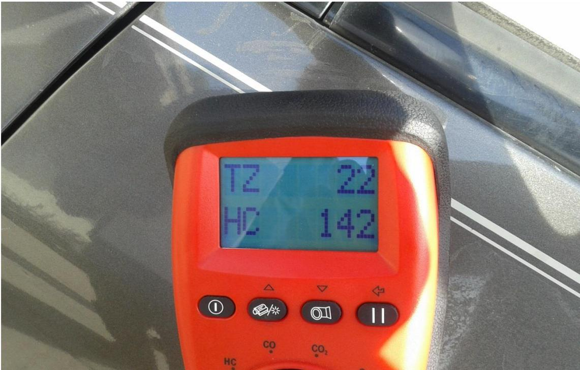
Esta foto muestra el analizador snap-on iniciando la prueba de gases
