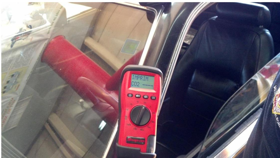
Analizador de gases snap-on calibrándose previa prueba.
